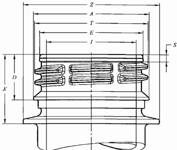
$Z$ —支撑环直径; $A$ —锁环直径; $T$ —螺纹直径; $E$ —瓶口直径; $I$ —瓶口内径; $S$ —螺纹开端; $D$ —锁环高度; $X$ —瓶口高度。
